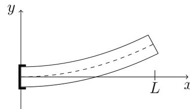
Le modèle le plus simple permet de décrire le mouvement de la poutre par l'équation d'Euler-Bernoulli
