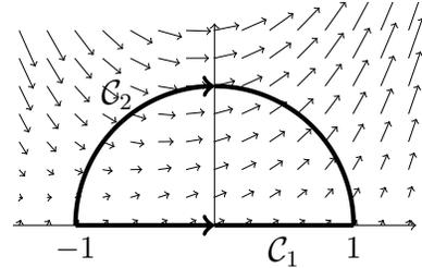
Nous considérons deux chemins allant du point  $(-1, 0)$  au point  $(1, 0)$  : le segment horizontal  $\mathcal{C}_1$  et le demi-cercle  $\mathcal{C}_2$ . Nous souhaitons déterminer le chemin sur lequel la contribution du champ  $\vec{\varphi}$  au déplacement est la plus forte.
