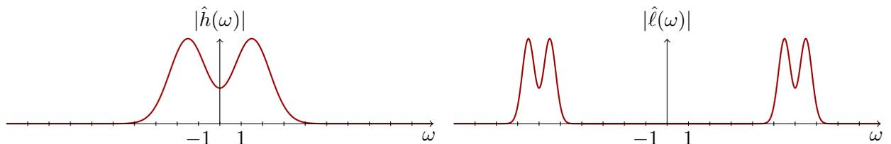
Pour passer de  $h$  à  $\ell$ , il faut d'abord contracter son spectre pour le ramener de la bande de fréquence  $[-3, 3]$  à la bande de fréquence  $[-1, 1]$ . Il faut donc le contracter d'un facteur 3. Nous posons ainsi  $h_1(t) = h(\frac{t}{3})$ , pour obtenir  $\widehat{h}_1(\omega) = 3\widehat{h}(3\omega)$ . Comme nous ne souhaitons pas augmenter l'amplitude du spectre, nous divisons ensuite  $h_1$  par 3.
